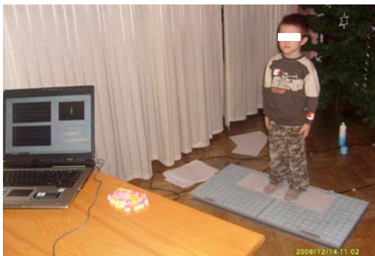
RYCINA 3.1. Stanowisko badawcze: 2 platformy AccuSway wraz z przetwornikiem analogowo-cyfrowym i komputer przenośny
