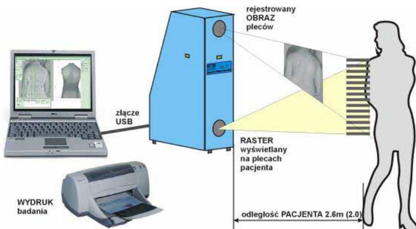
RYCINA 3. Wyposażenie stanowiska badawczego do fotogrametrycznej oceny postawy ciała (CQ Elektronik System, Artur Świerc, www.cq.com.pl )
